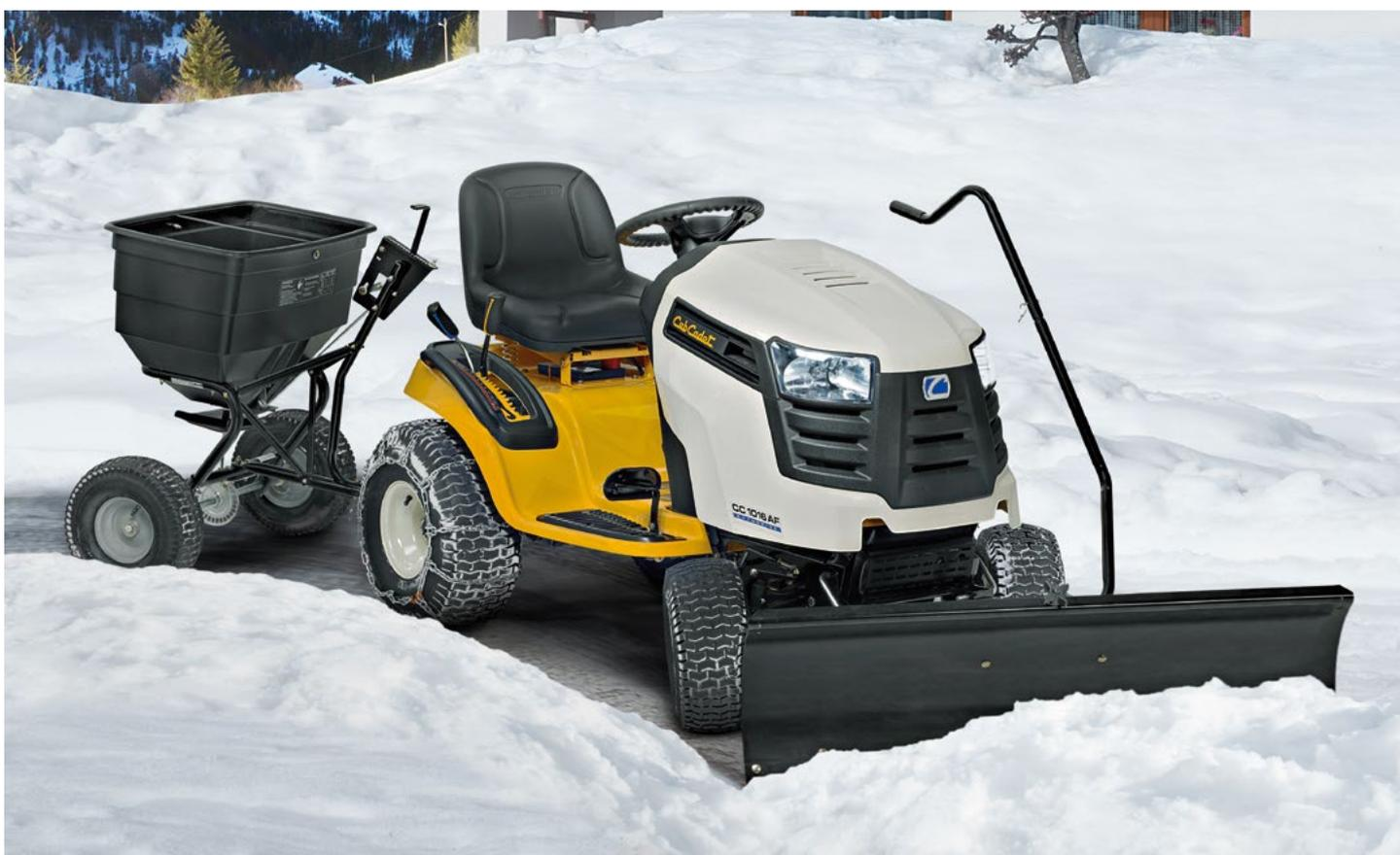
Primjer traktora sa ralicom, rasipačem i lancima.
